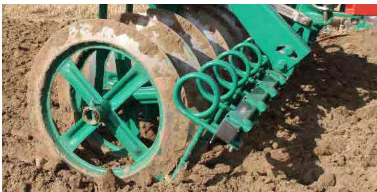
Одинарная борона с передним расположением: стойки 16 мм с обратными долотами или 20 мм стойки с ножами
