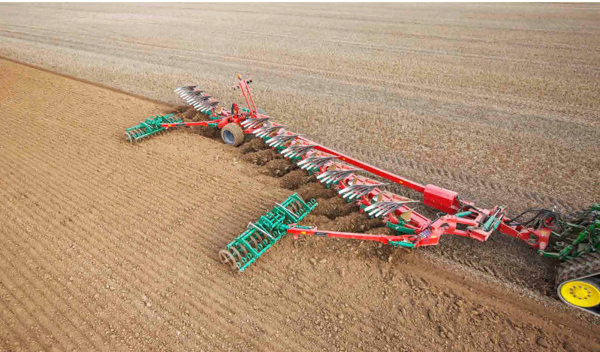
Для навесных моделей плугов до 6 корпусов До 12 корпусов для РW/RW полунавесных плугов в комбинации с 2 катками
